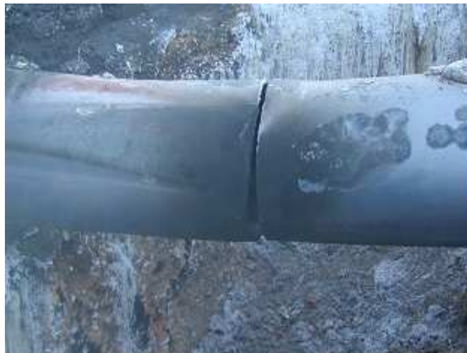
Рис. 18. Фото трубы при аварии (к предыдущей схеме).
