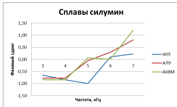
Рис. 4. Результаты исследований литейных сплавов типа Силумин.
