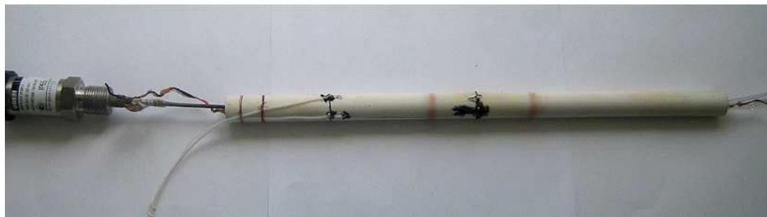
Рис. 2. Внешний вид реактора – теплогенератора перед установкой в калориметр.
