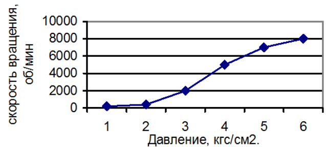
Рис. 4. Зависимость скорости вынужденного вращения осевого сердечника ( \varnothing 6 мм) от давления на входе вихревой трубы.
