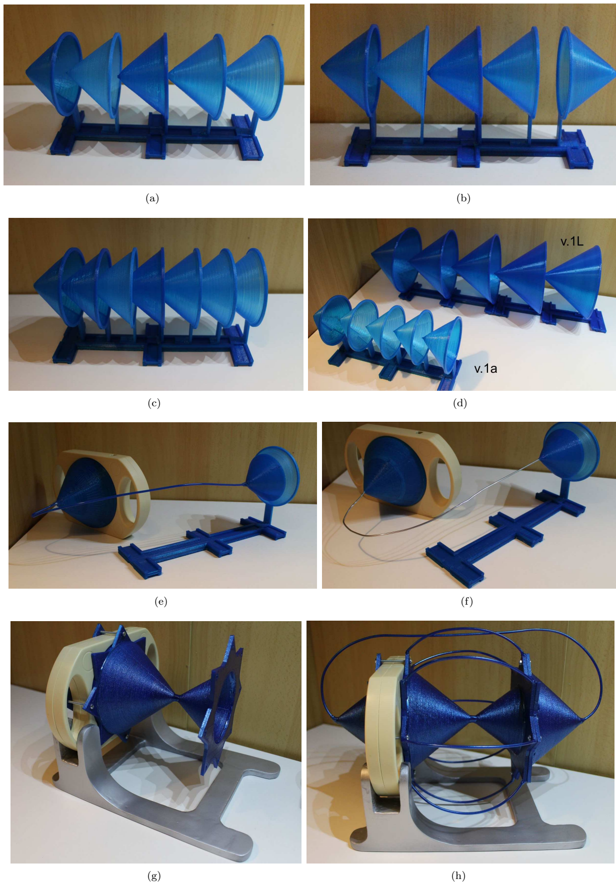
Рис. 26. Структурные элементы (СЭ), используемые в экспериментах. (а) Вариант 1, использовалось направление 'вершины к сенсорам' (вариант 1а) и 'основания конусов к сенсорам' (вариант 1б); (б) Вариант 2, крайний правый конус направлен к сенсорам; (с) Вариант 3: 7 конусов вставленные в друг друга на 1/3 их высоты; (е) Вариант 1L (large): повторение варианта 1а, но с большими конусами, для сравнения приведен СЭ варианта 1а; (е,ф) Конусы соединены диэлектрическим и металлическим 'волноводом'; (г) Вариант 4 и (h) Вариант 5: сложные геометрии СЭ, образованные как соединительными элементами, так и различными конусами, укрепленными непосредственно на излучателе.
