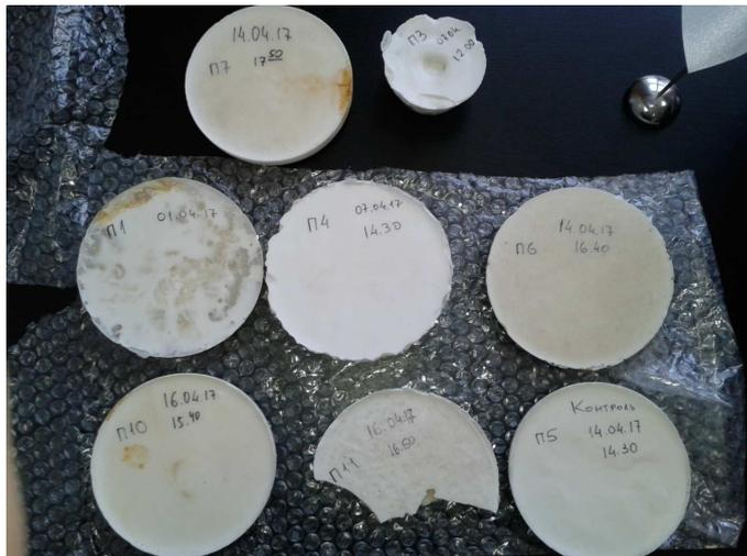
Рис. 10. Фотография контрольного и опытных образцов полипропилена.
