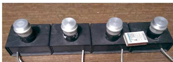
Рис. 6. (а) - Результаты суточного мониторинга фоновых сигналов Биоскопа; (б) - Четыре Биоскопа располагаются рядом. Расстояние между датчиками порядка 10 см. На датчиках установлена алюминиевая пластина (1 см) для сглаживания и снижения влияния естественных физических процессов в самой лаборатории в процессе длительной регистрации сигналов Биоскопов.
