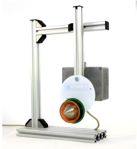
Рис. 14. CPV излучатель без закрывающего конуса, установленный на пластиковом держателе.
