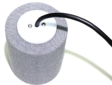
Рис. 31. Световая и температурная изоляция контейнеров в эксперименте 'макро-запутанными' жидкостями (вспененный полиэтилен 13 мм в виде трубы, внутрь которой вставлены ЭИС контейнеры).
