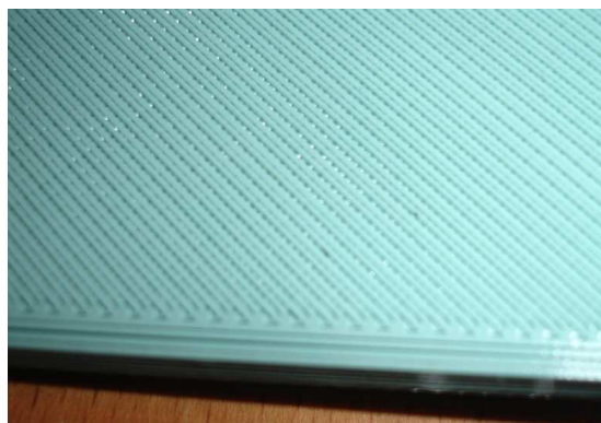
Рис. 1. Крышки светодиодных генераторов, распечатанные на 3D RepRap принтере из PLA (полиактид) пластика с продольно-поперечной структурой волокон и уровнем заполнения 90%.
