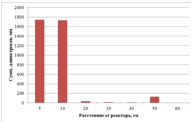
Рис. 7. Результаты эксперимента с различным расстоянием дисков от водного реактора.
