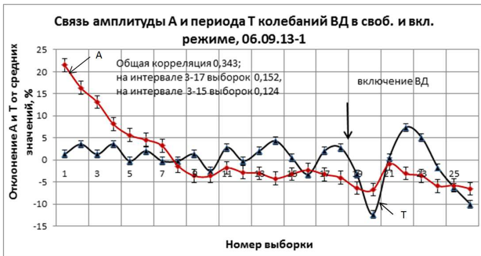
Рис. 18. Исследование взаимной обусловленности амплитуды и периода колебаний системы ВД. Общая корреляция оказалась 0,343, на интервале 3-17 выборок 0,152, а на интервале 3-15 выборок 0,124.
