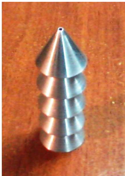
Рис. 6. Сборка конусов, материал Д16Т, диаметр 28 мм.
