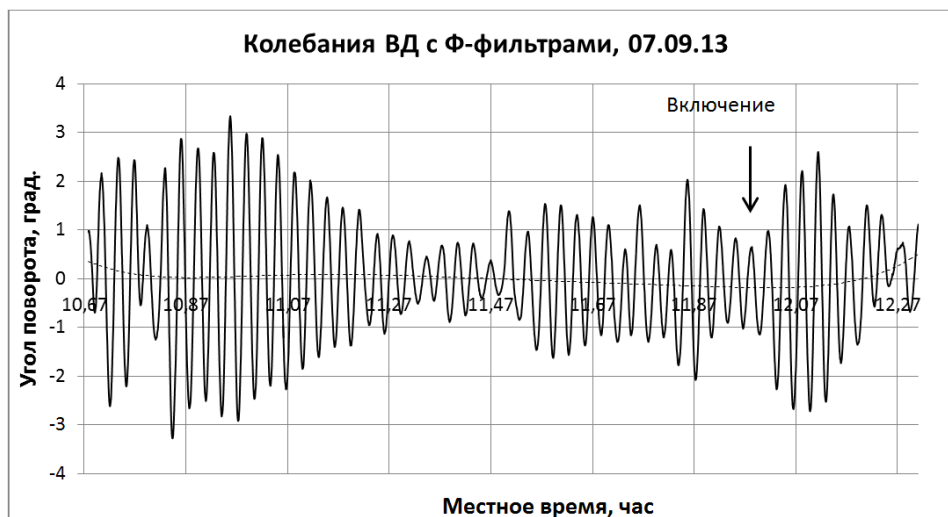
Рис. 20. Колебания системы в выключенном режиме ВД и Ф-пробками.
