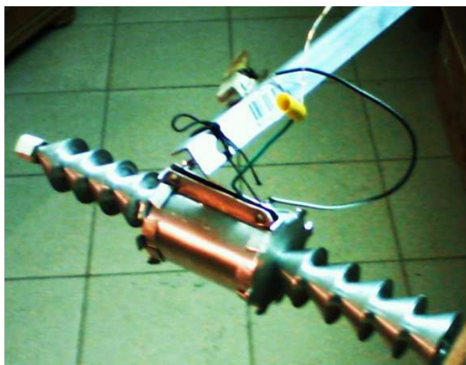
Рис. 7. Сборка ВД на подвесе.
