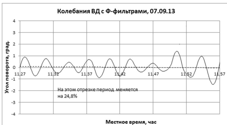
Рис. 21. Фрагмент записи колебаний системы с ВД с оценкой variability периода.
