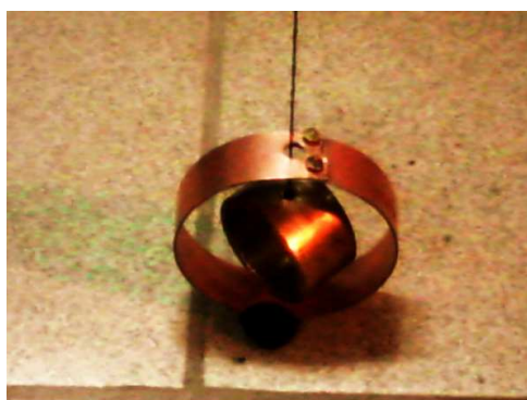
Рис. 16. Контрольный опыт с парой короткозамкнутых медных колец. Внутреннее кольцо подвижно в составе крутильного маятника, а наружное кольцо неподвижно и имеет отверстие для прохода нити подвеса внутреннего кольца. Начальное положение внутреннего кольца параллельно наружному.
