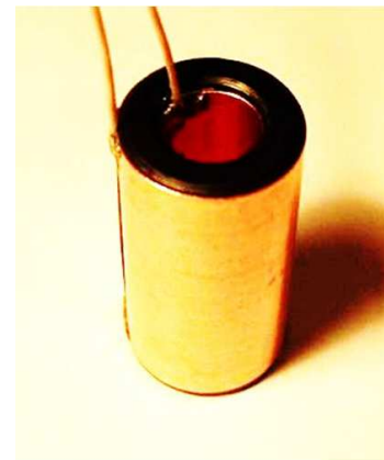
Рис. 3. Конденсаторная часть генератора В.Замши
