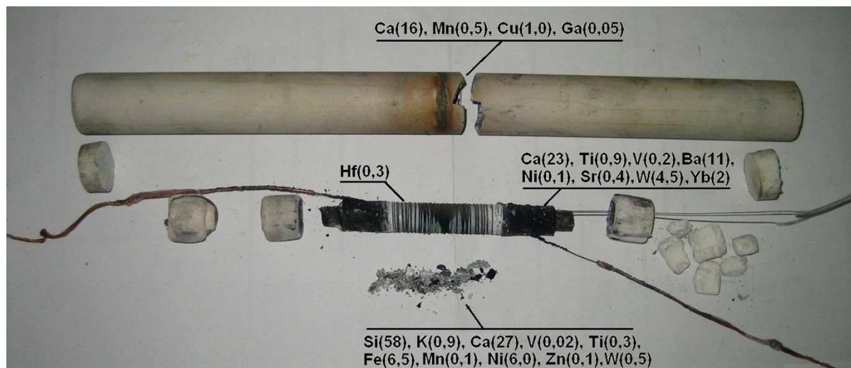
Рис. 9. Реактор после завершения работы. Показано содержание элементов (%) в некоторых местах, где были взяты пробы. Остальную массу в основном дают входящие в состав керамики Al и Si.
