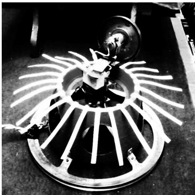
Рис. 4. Индикация силового поля под летающим гироскопом. На кольцевую рампу наклеивались длинные полоски из бумаги, которые отгибались вниз в виде волны при "пролёте" над ними гироскопа. При вращении гироскопа в отсутствие прецессии (полёта) полоски практически не отклонялись.
