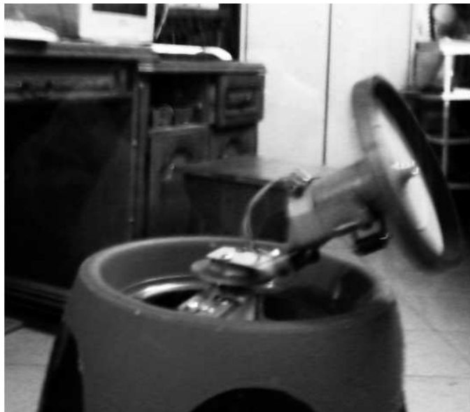
Рис. 3. Общий вид устройства для демонстрации «полёта» гироскопа. Облегчение старта «полёта» достигается установкой под электродвигателем гироскопа обрезиненного колеса-шасси, которое может при разбеге катиться по кольцевой рампе. Примечание: Под ротором гироскопа можно наблюдать странное «размытие» изображения фоновых предметов: пола и стеллажа.
