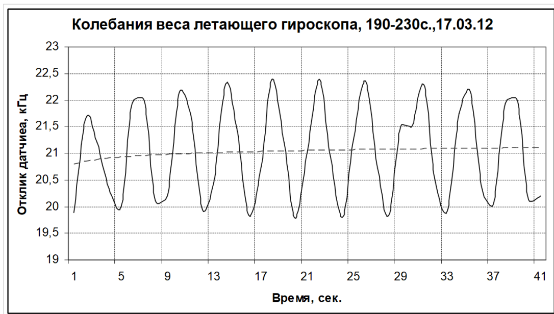
Рис. 9. Сглаженный участок колебаний в диапазоне 190-230 сек. Неравномерность амплитуды колебаний объясняется взаимным скольжением фазы считывания АЦП по отношению к фазе колебаний. Частота считывания 1 Гц, а частота колебаний сигнала в данных условиях около 0,244 Гц, т.е. на период колебаний приходится всего 4 точки считывания с некоторым скольжением из-за некратности частот.
