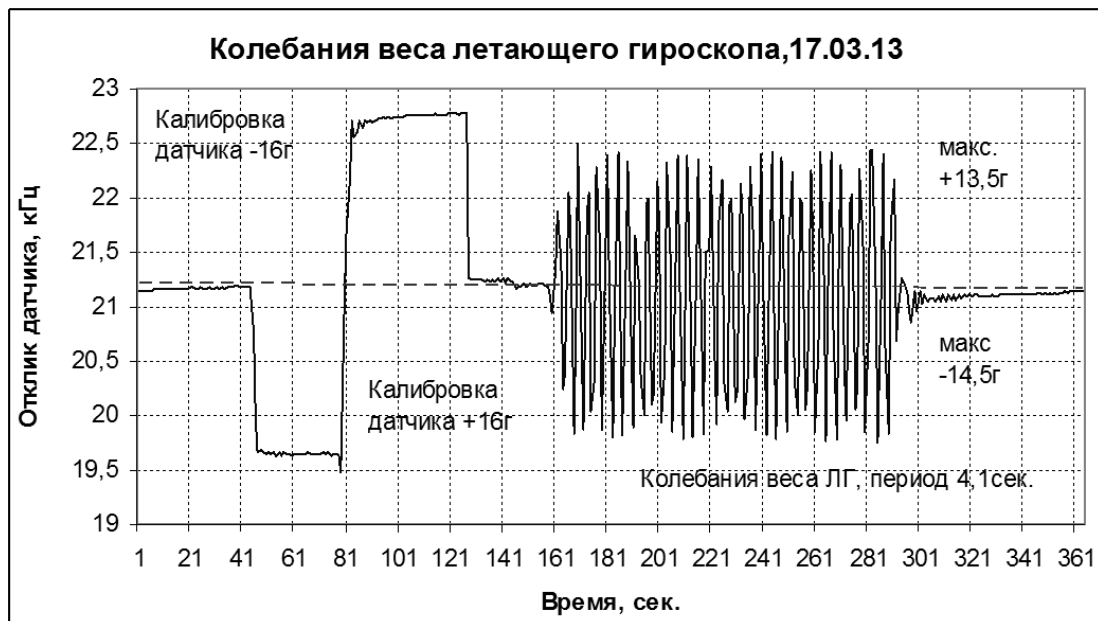
Рис. 8. Запись в ПК калибровочной кривой (левая половина) и колебаний системы, связанных с положением диска гироскопа: над балкой и за её концом.
