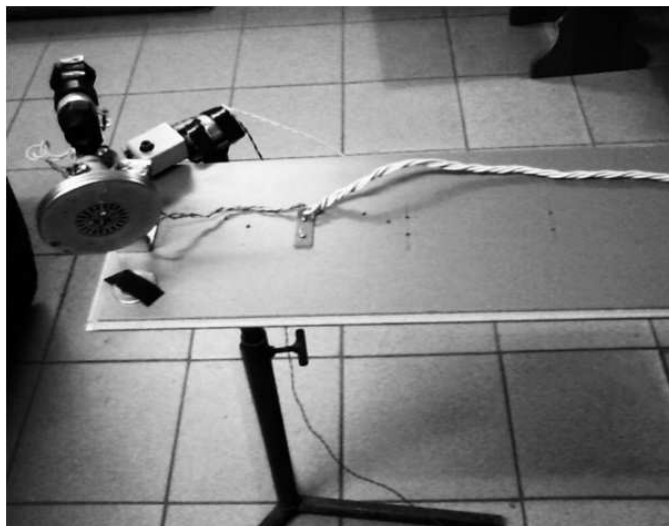
Рис. 5. Установка №2 - механизм "летающего" гироскопа установлен на конце длинной упругой балки, оснащённой индуктивным датчиком вертикального перемещения и аналого-цифровым преобразователем.
