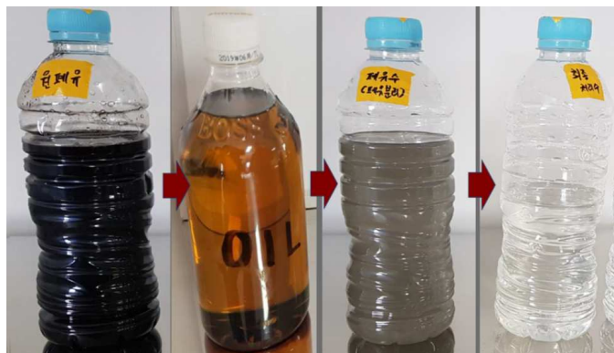
Рис. 4. Результаты очистки воды в одной из бухт Южной Кореи: 1) образец загрязнённой воды; 2) выделенное после очистки масло; 3) оставшаяся после сепарации масла вода; 3) окончательно очищенная вода.
