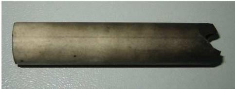
Рис. 3. Фрагмент реактора в виде двухрожковой вилки.
