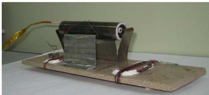
Рис. 3. Галогенная лампа накаливания внутри цилиндрического контейнера.
