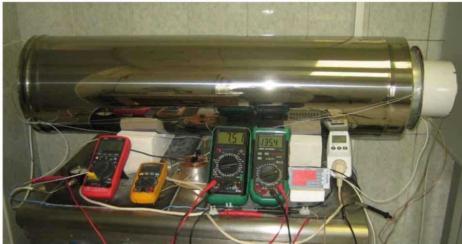
Рис. 4. Воздушный проточный калориметр.
