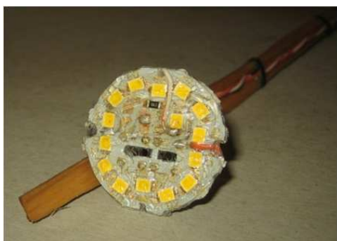
Рис. 7. Светодиоды, использованные в калориметрическом эксперименте.
