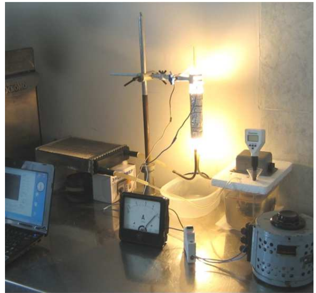
Рис. 1. Экспериментальная установка с циркулирующим раствором KNO_3 и галогенной лампой накаливания.
