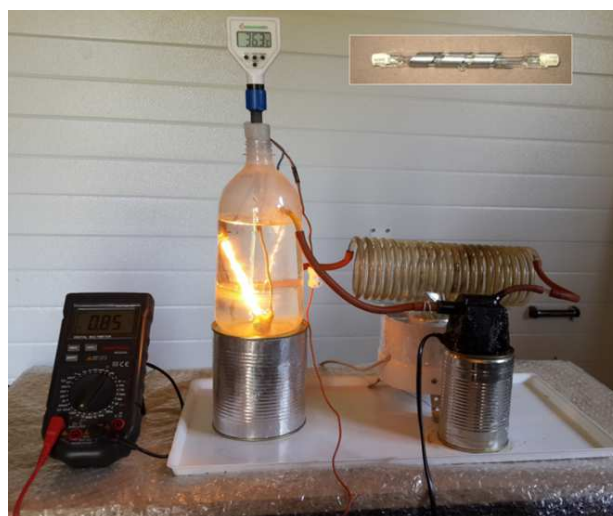
Рис. 2. Галогенная лампа накаливания, обёрнутая лентой из сплава олово-свинец в сосуде с водой. Вода прокачивается через змеевик, охлаждаемый вентилятором.
