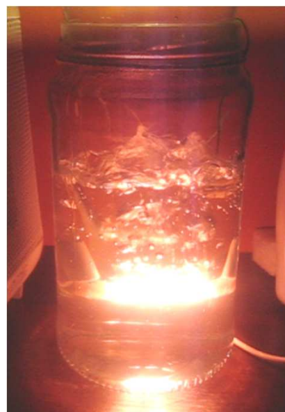
Рис. 3. Галогенная лампа накаливания в кипящей воде с суспензией NaBiO_3 .
