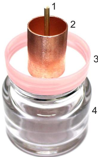
Рис. 2. Конструкция асимметричного сенсора, 1 – латунный штыревой электрод, 2 – цилиндрический медный электрод, 3 – пластиковая крышка (показана в перевернутом состоянии), стеклянный контейнер 50 мл.
