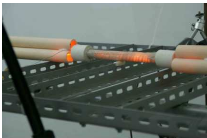
Рис. 1. Реактор во время испытаний. С каждой стороны расположено по три керамических трубы с проводами, по которым подводится электропитание, необходимое для предварительного разогрева реактора.
