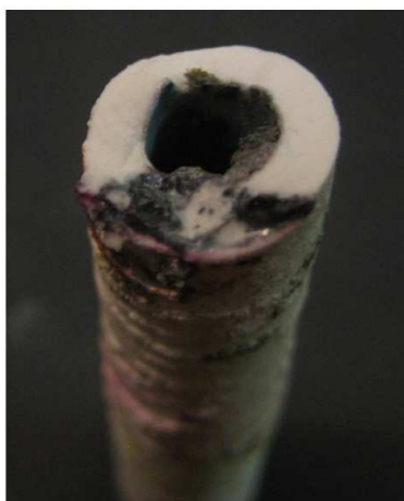
Рис. 9. Разрушенный в результате локального разогрева участок реактора.
