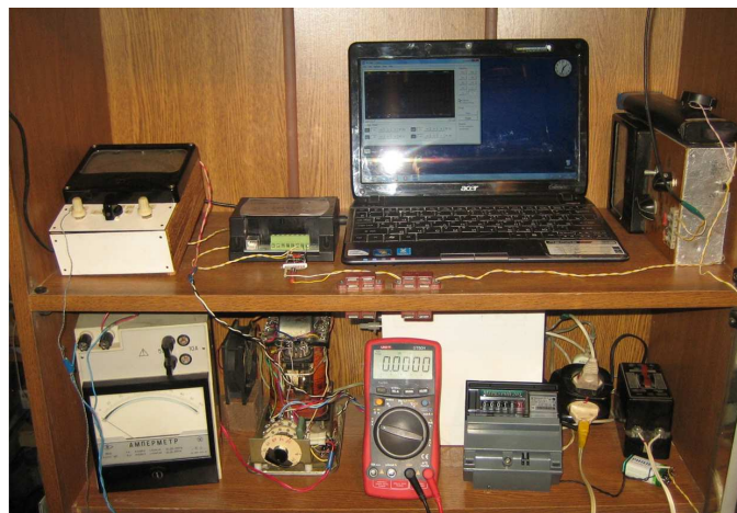
Рис. 3. Комплекс аппаратуры для электропитания нагревателя и диагностики. Слева направо сверху: усилитель сигнала термопары с регулятором мощности, компьютерный самописец, компьютер для регистрации температуры и скорости счета счетчика Гейгера, устройство для измерения скорости счета счетчика Гейгера. Слева направо внизу: амперметр, блок электропитания реактора, вольтметр, электронный электросчетчик “Меркурий”, выключатель электросети.
