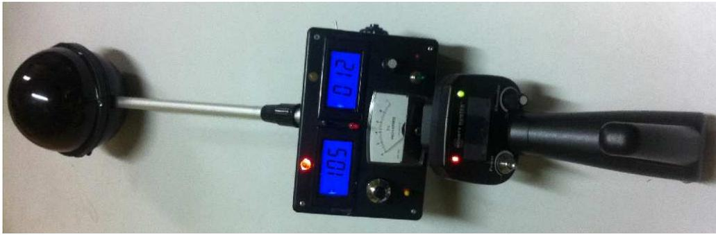
Рис. 18. SEVA-Integral-M1. Наиболее поздняя разработка из семейства SEVA. Этот прибор первый, где квази-стационарное и нестационарное вращение ПГ разделены. Прибор регистрирует широкополосное вращение до 250 МГц.
