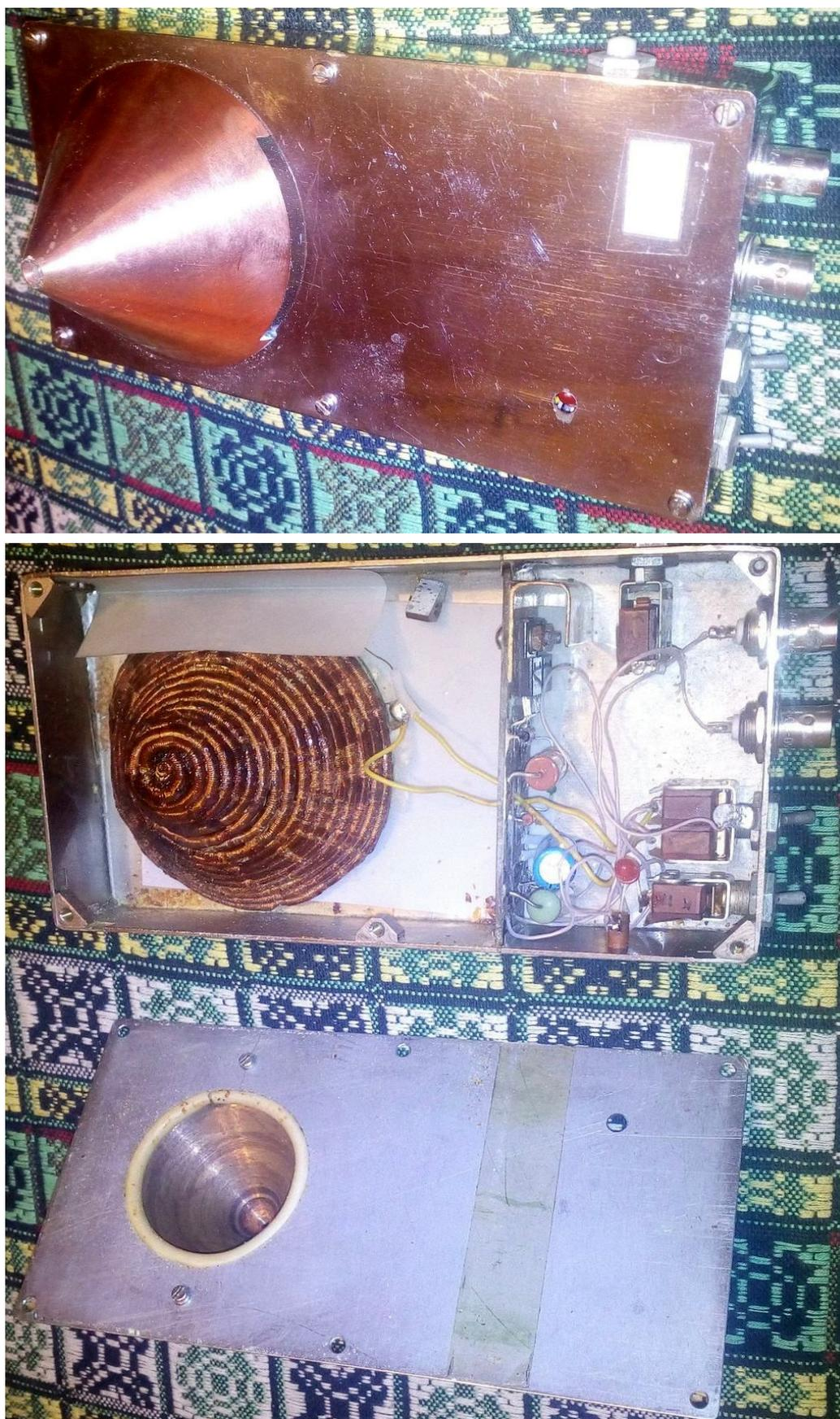
Рис. 11. Внешний вид прототипа МГА с открытой верхней панелью.
