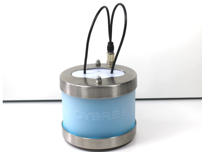
Рис. 5. Дифференциальный импедансный спектрометр на системе MU EIS с температурной стабилизацией проб и электронных компонентов.
