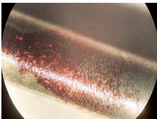
Рис. 12. Новые элементы на поверхности W электрода [21].
