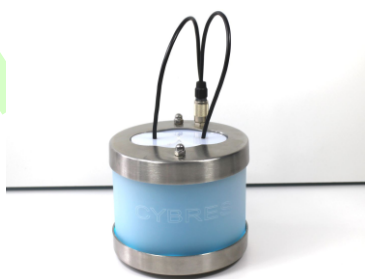
Дифференциальный импедансный спектрометр с температурной стабилизацией проб и электронных компонентов
