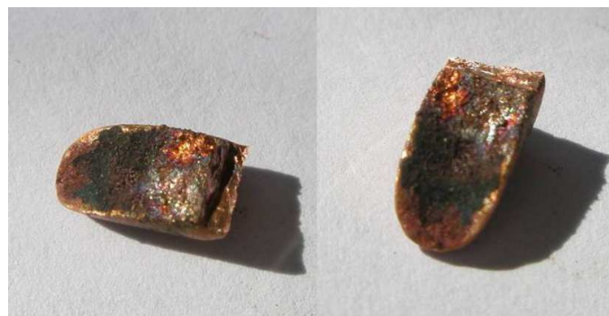
Рис. 10. Фрагмент торца анода после завершения эксперимента.
