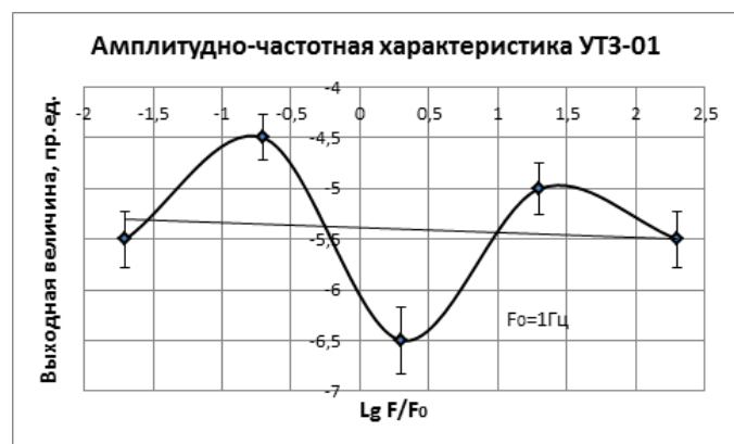
Рис. 11. АЧХ затвора УТЗ-01. Каждая точка получена усреднением 6 измерений с включением управления затвором и по сравнению с 7 значениями фона при его выключении. Видны осцилляции амплитуды, вероятно связанные с пространственно-частотными резонансами в системе связи БГА и ТСМ-021 через УТЗ-01. Неравномерность АЧХ равна 18%.
