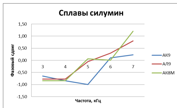
Рис. 4. Результаты исследований литейных сплавов типа Силумин.
