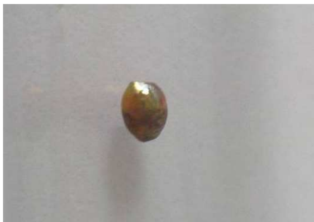
Рис. 3. Каплеобразный медный шарик, поверхность которого анализировалась по химическому элементному составу.
