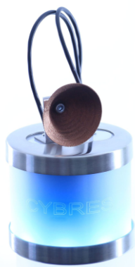
ЭИС спектрометр с приемным конусом, установленном в экспериментальном канале (С. и О. Кернбах).
