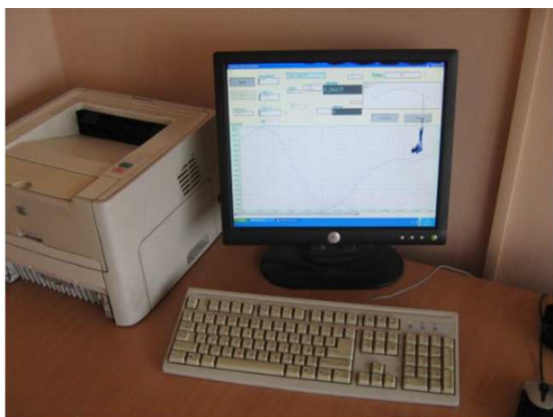
Рис. 4. Монитор для визуализации электрического сигнала, снимаемого с алоэ.
