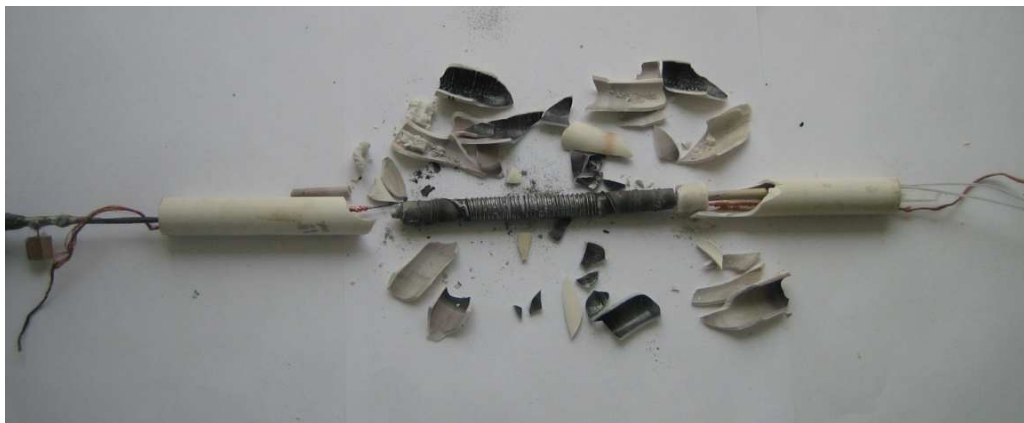
Рис. 3. Реактор 'Проток 6' после вскрытия.
