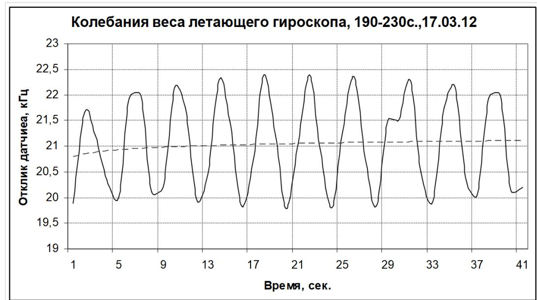
Рис. 9. Сглаженный участок колебаний в диапазоне 190-230 сек. Неравномерность амплитуды колебаний объясняется взаимным скольжением фазы считывания АЦП по отношению к фазе колебаний. Частота считывания 1 Гц, а частота колебаний сигнала в данных условиях около 0,244 Гц, т.е. на период колебаний приходятся всего 4 точки считывания с некоторым скольжением из-за некратности частот.
