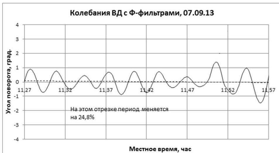
Рис. 21. Фрагмент записи колебаний системы с ВД с оценкой вариабельности периода.
