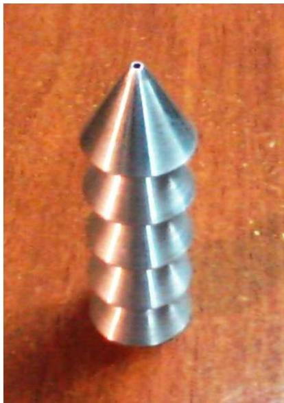
Рис. 6. Сборка конусов, материал Д16Т, диаметр 28 мм.
