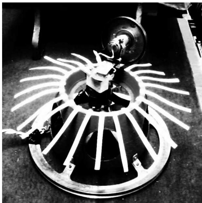
Рис. 4. Индикация силового поля под летающим гироскопом. На кольцевую рампу наклеивались длинные полоски из бумаги, которые отгибаются вниз в виде волны при "пролёте" над ними гироскопа. При вращении гироскопа в отсутствии прецессии (полёта) полоски практически не отклонялись.
