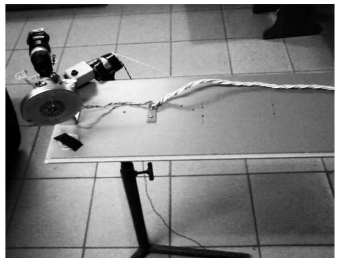
Рис. 5. Установка №2 - механизм "летающего" гироскопа установлен на конце длинной упругой балки, оснащённой индуктивным датчиком вертикального перемещения и аналогово-цифровым преобразователем.
