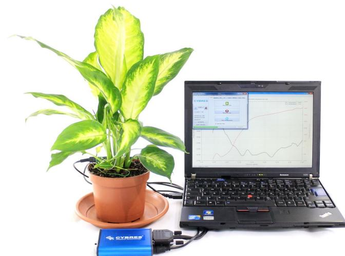
Рис. 2. Фитосенсор – растение *Dracaena* с подключенными сенсорами, снимающими показания электрофизиологии (биопотенциалы и проводимость тканей).
