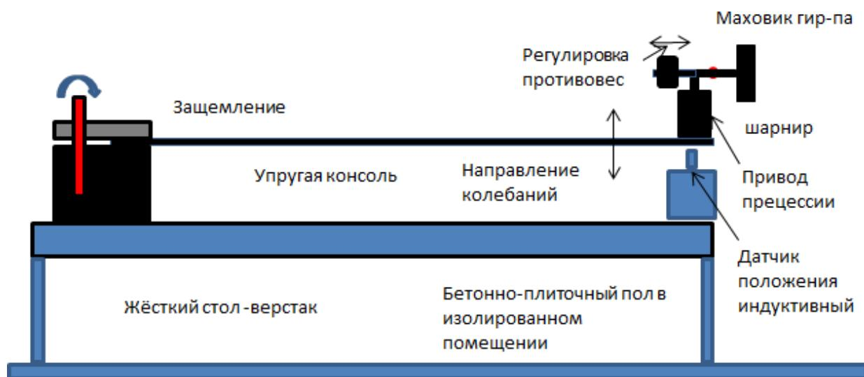
Рис. 6. Схема установки №2 с балкой с одним защемлением.
