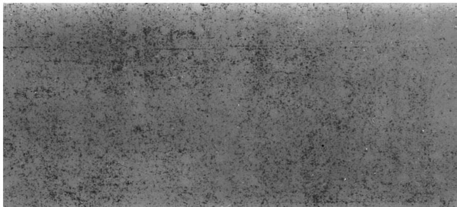
Рис. 6. Фотоплёнка, экспонированная при соприкосновении фрагмента реактора и полистирольной кассеты с фотоплёнкой без использования картонного экрана.
