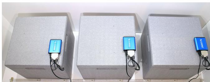
Рис. 1. Фотография 3 контейнеров из неопора с ЭИС системами, объем 0.036 м<sup>3</sup> и толщина стенки 5 см, внутри которого находятся 4,5-5 литров воды (или термогеля), суммарный габарит трех контейнеров 120 см.
