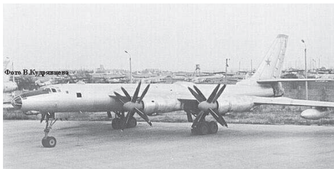
Рис. 16. Ту-95ЛАЛ (Ту-119) с ядерными турбовинтовыми двигателями НК-14А. На фюзеляже сверху виден фонарь над реактором.
