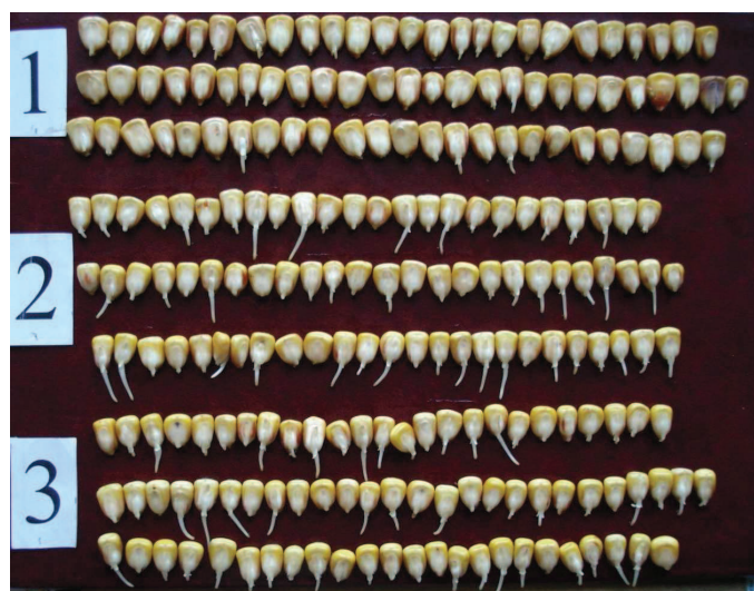
Рис. 9. Экспериментальная серия 5: Прорастающие семена кукурузы (приемники ЭНС) при воздействии на семена (индукторы ЭНС) температурного и механического факторов 1 – контроль; 2 – кипящая вода, 3 – измельчение семян; три ряда семян каждого варианта – семена, изъятые из трех чашек Петри (200 штук).
