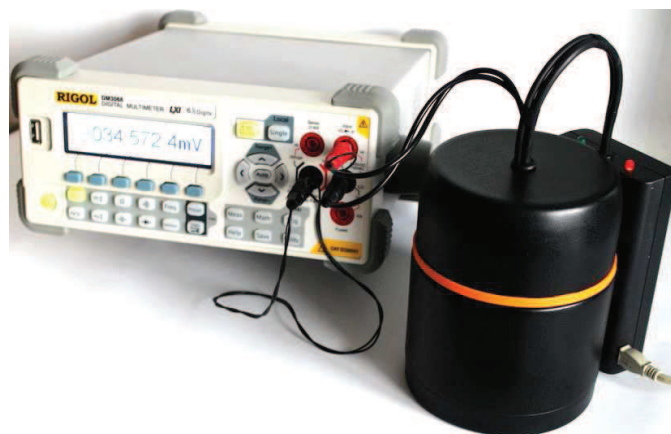
Рис. 9. Подключение сенсора к стационарному прецизионному мультиметру с VISA интерфейсом. Используется термостабилизированный контейнер от 'настольной ЭБХ лаборатории'.
