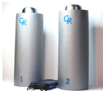
Прецизионный дифференциальный USB pH-метр Cybertronica Research (инженерный прототип).
