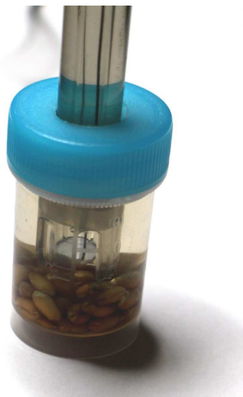
Рис. 5. Контейнер с зернами и водой от замоченных зерен. Используются pH электроды GE100 производства Greisinger Electronic.
