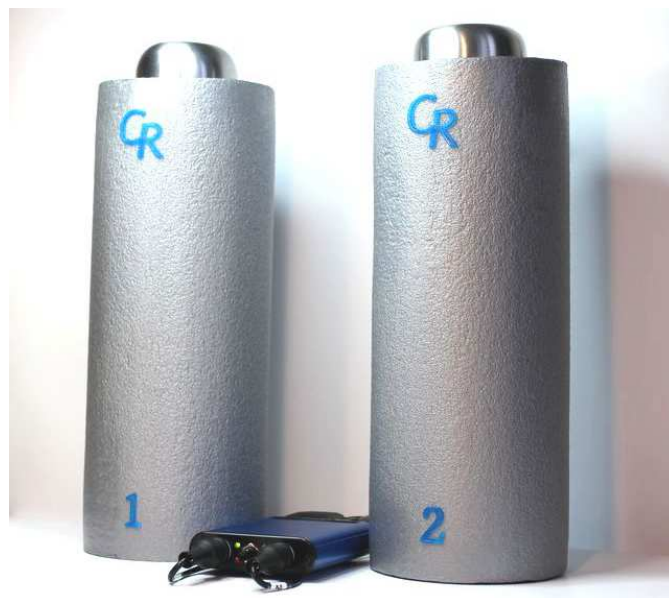
Рис. 3. Прецизионный дифференциальный USB pH -метр на основе MU2.0 (инженерный прототип).
